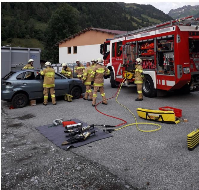
Die besondere Herausforderung bei den heutigen Fahrzeugen ist zu erkennen, wo kann oder darf ich bei einer Menschenbergung schneiden oder spreizen. Für die Fahrzeugmarken und Typen gibt es eigene Rettungsdarstellungen der Hersteller, wo sich die verschiedenen Einbauten im Fahrzeug befinden. Besonders problematisch sind Hybrid- und Elektrofahrzeuge mit Hochspannungsbereichen, die für die Einsatzkräfte lebensgefährlich sein können.
